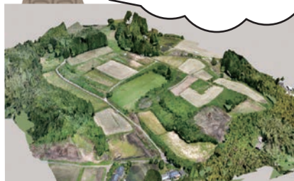
現況図の3次元化 (ドローンによる測量)
