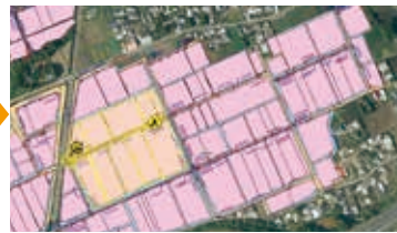
農地や施設の情報を地図上で管理 (黄色着色：漏水影響範囲)
